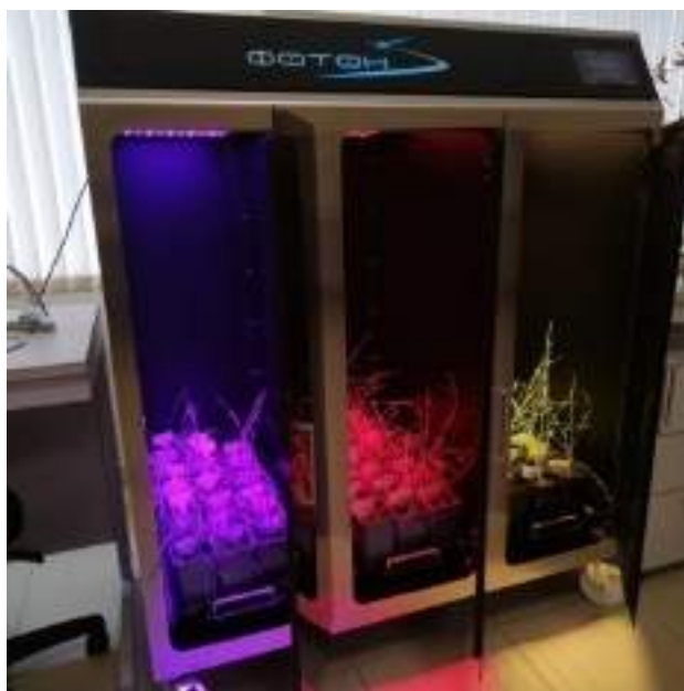
Установка Фотон для изучения влияния спектрального состава на развитие растений, исследовательские работы в обновленной лаборатории
