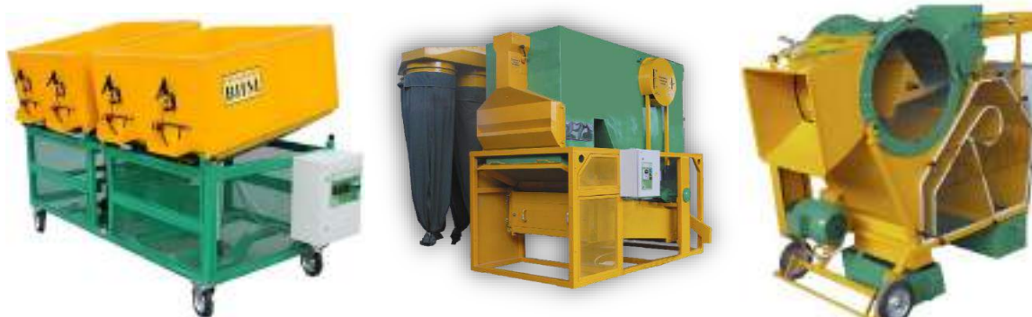
Оборудование селекционных лабораторий. Слева направо: сушилка лотковая СЛ-0,3×2, пневмосортировальная машина ВИМ-1 «Селекция», молотилка-терка пучковая универсальная МТПУ-500
