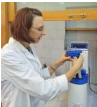
Определение числа падения на приборе ПЧП-7.
