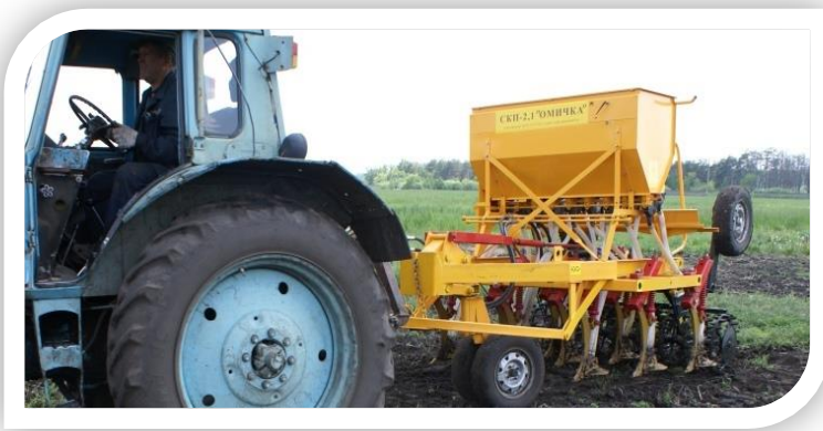
Сеялка с сошником для разноглубинного посева и внесения минеральных удобрений
