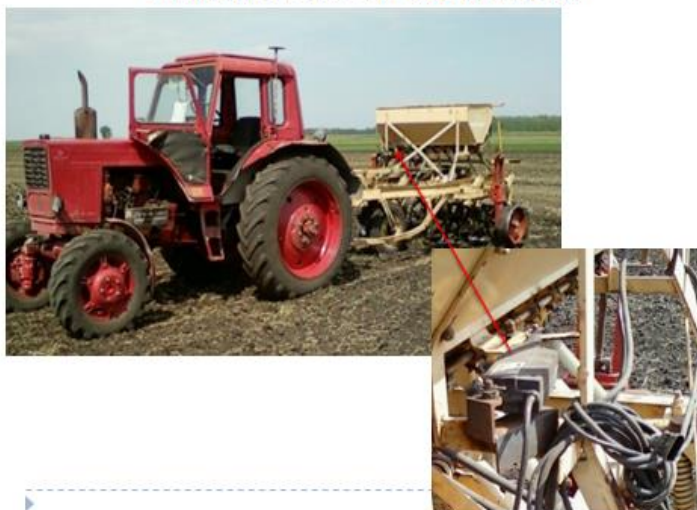
Рисунок 3 – Дозирующий аппарат сеялки СКП-2,1 при дифференцированном внесении минеральных удобрений
