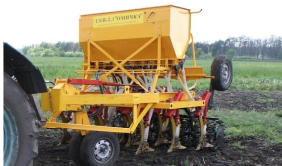
Сеялка СКП-2,1М с экспериментальными комбинированными сошниками
